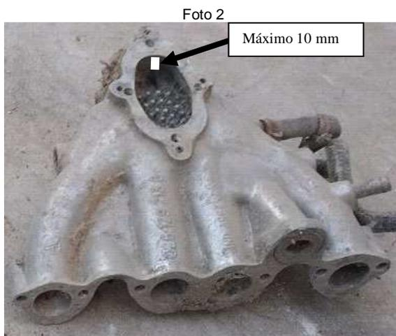
No se podrá poner juntas debajo del mezclador, ni cortar los pernitos de aluminio, que deberán medir no menos de 16mm desde la base.
