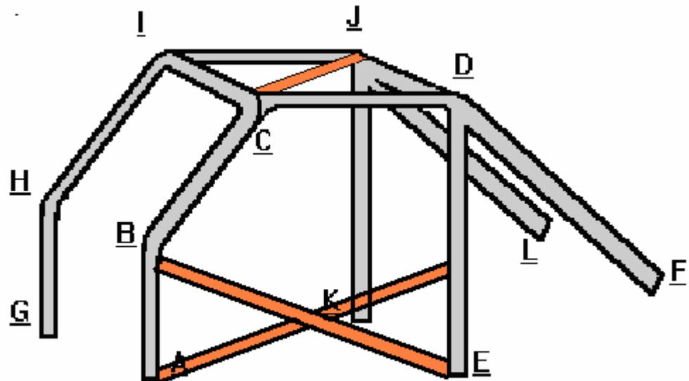
Es obligatoria la instalación de una estructura de seguridad, la cual deberá ser homologada ante la CDA del ACA, y construida con tubos de acero sin costura, trefilados, de sección circular, de acero calidad SAE 1020, de 38 mm de diámetro exterior y 2.5 mm de pared (o 40 mm de diámetro y 2 mm de pared).
