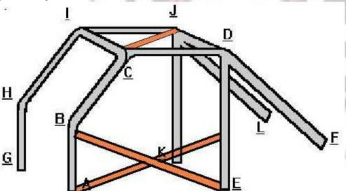
Los puntos A y G del arco delantero, y los E y K del arco principal, y los puntos F y L de los tirantes Longitudinales deberán ser soldados a una planchuela de fijación 3/16, la cuál estará fijada al piso del vehículo por medio de bulones o soldadura.
