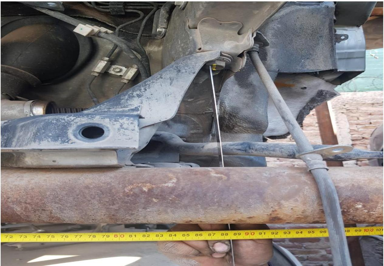
**MEDIDA DE ANCHO CUNA DE MOTOR CENTRO A CENTRO SUJECCION DE LARGUERO DE CARROCERIA (885 MM).**
