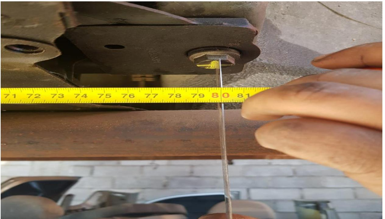
**MEDIDA DE ANCHO CUNA DE MOTOR CENTRO A CENTRO SUJECCION DE LARGUERO DE CARROCERIA (800 MM).**
