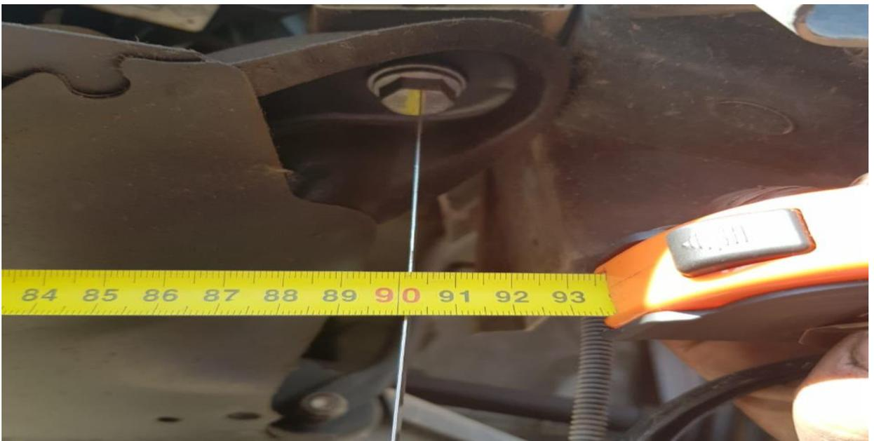
**MEDIDA ANCHO ANCLAJE CUNA DE MOTOR A LARGUEROS DELANTEROS DE CARROCERIA (900 MM).**
