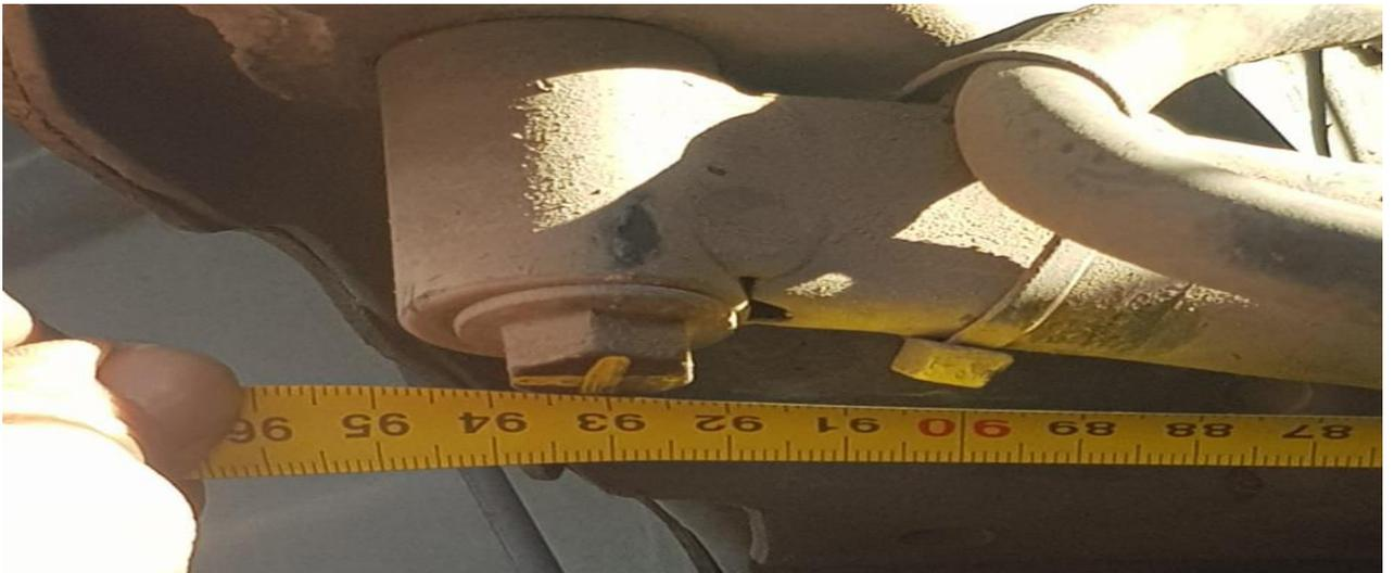
**MEDIDA DE ANCHO CUNA DE MOTOR CENTRO A CENTRO SUJECCION DE LARGUERO DE CARROCERIA (930 MM).**
