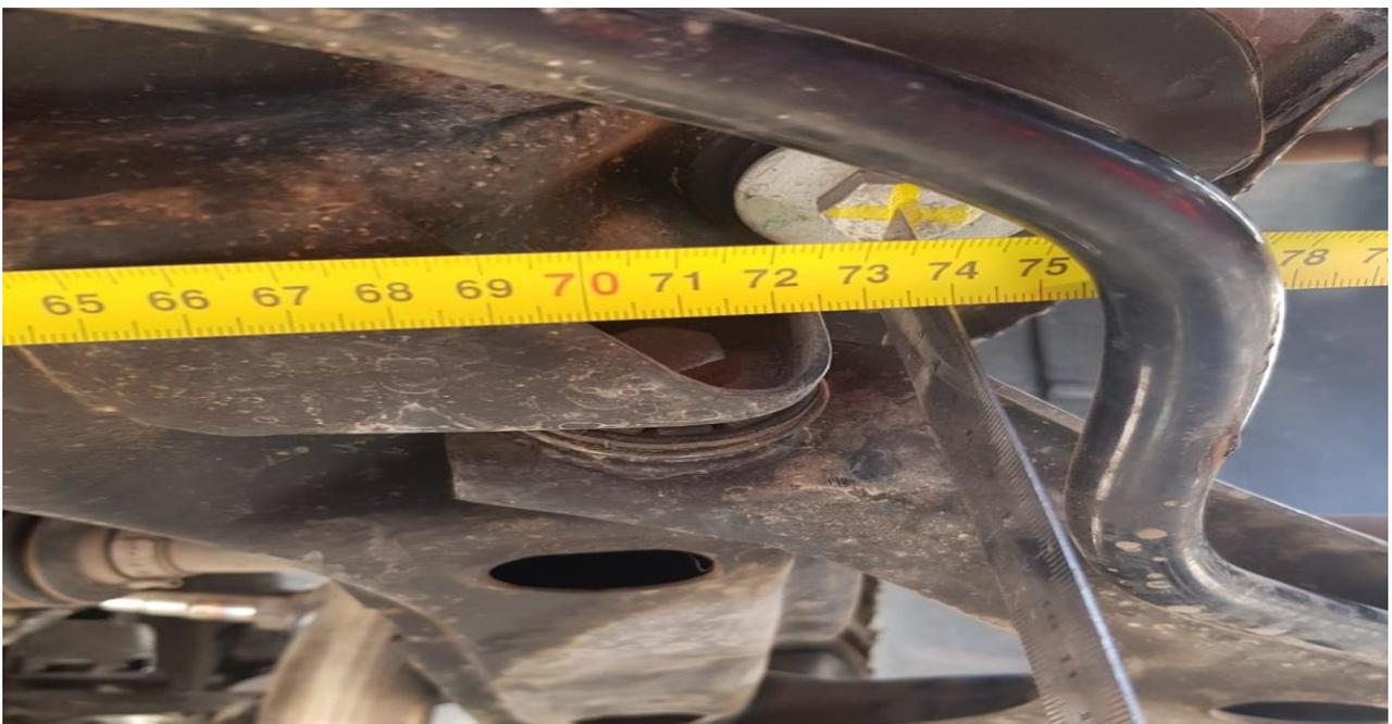
MEDIDA DE ANCHO CUNA DE MOTOR CENTRO A CENTRO SUJECCION DE LARGUERO DE CARROCERIA (740 MM).
