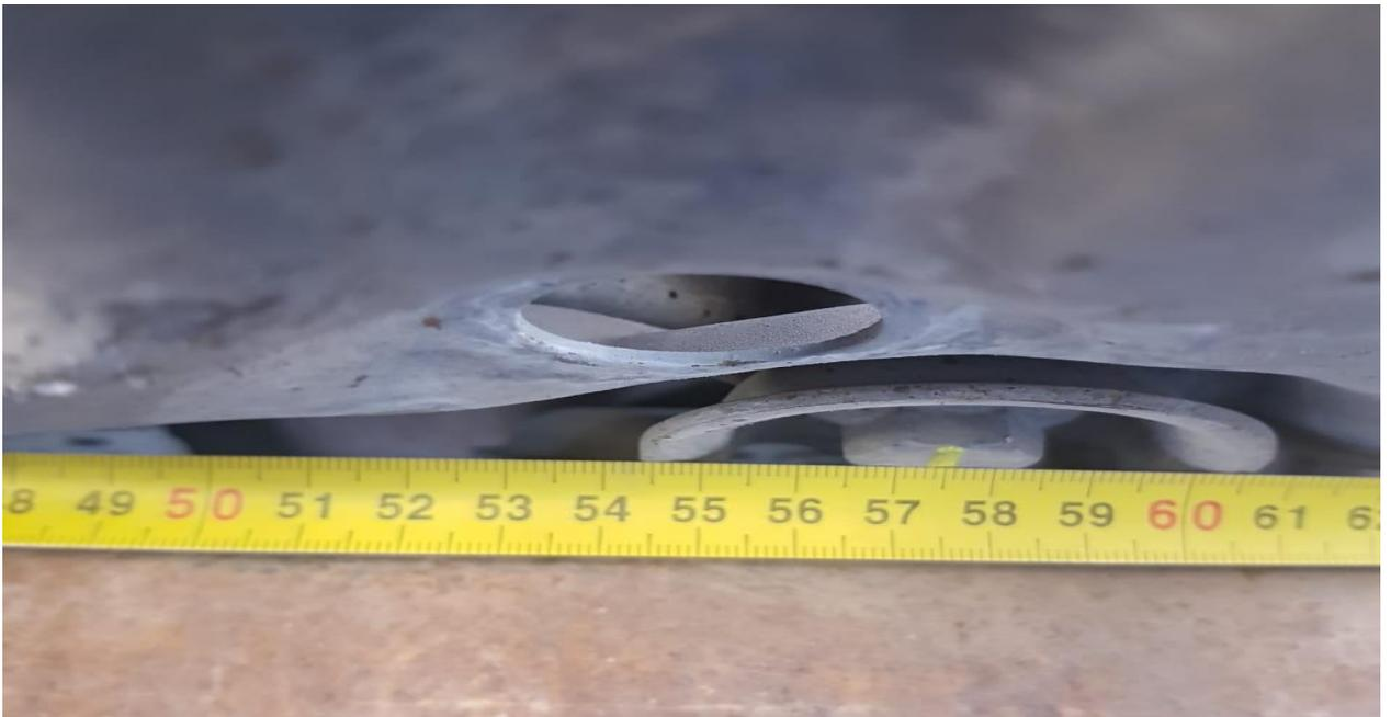
**MEDIDA DE ANCHO CUNA DE MOTOR CENTRO A CENTRO SUJECCION DE LARGUERO DE CARROCERIA (570 MM).**
