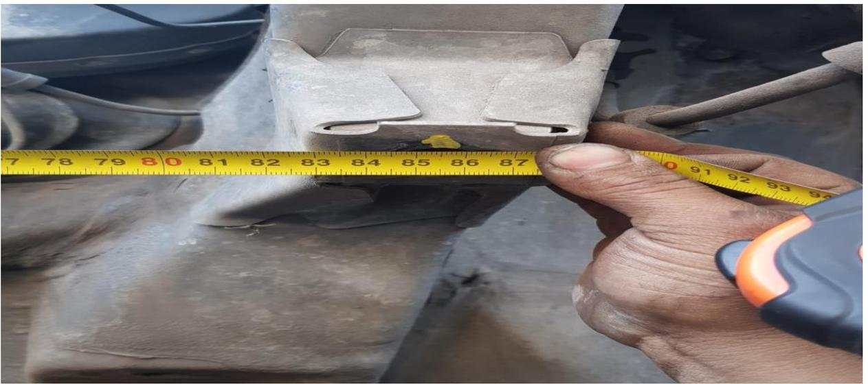
**MEDIDA DE ANCHO CUNA DE MOTOR CENTRO A CENTRO SUJECCION DE LARGUERO DE CARROCERIA (885 MM).**
