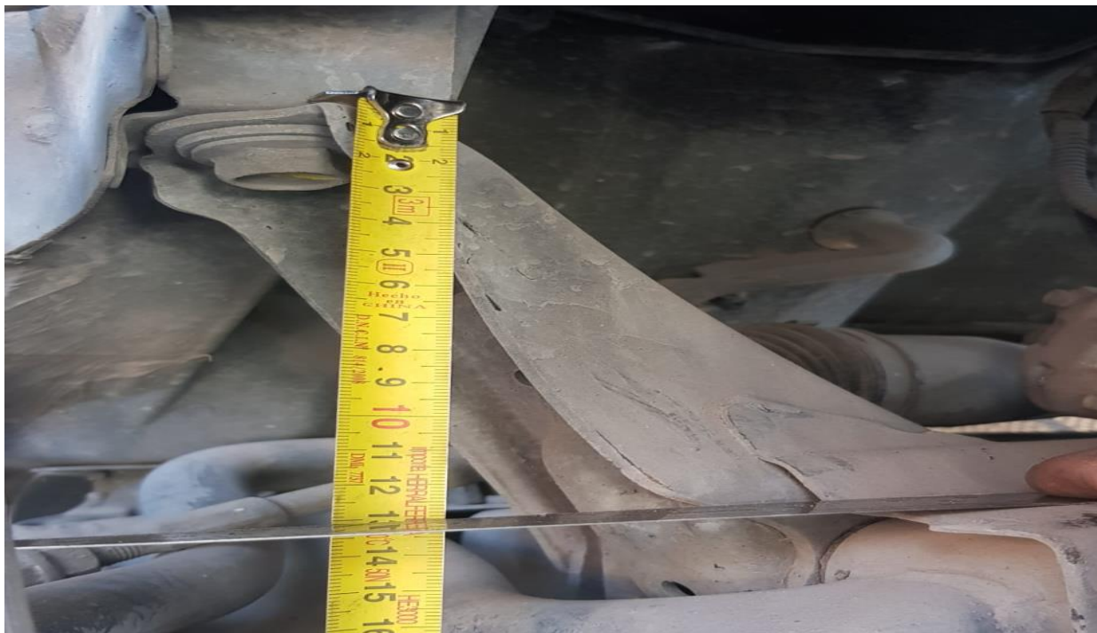
MEDIDA DE BRAZOS CUNA DE MOTOR A ANCLAJE DE CARROCERIA (130MM).
