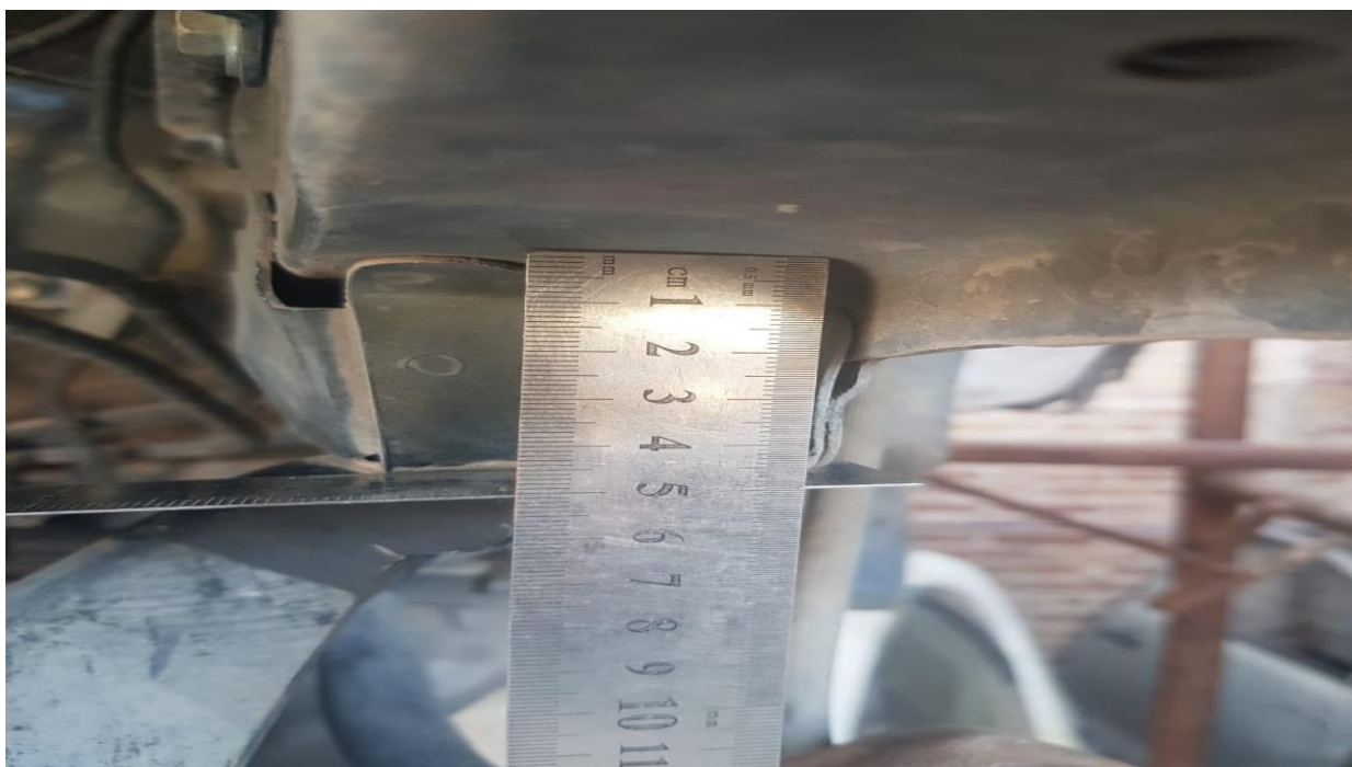
MEDIDA ANCLAJE CUADRANTE DE BRAZOS DE CARROCERIA A CUNA DE MOTOR (50 MM).
