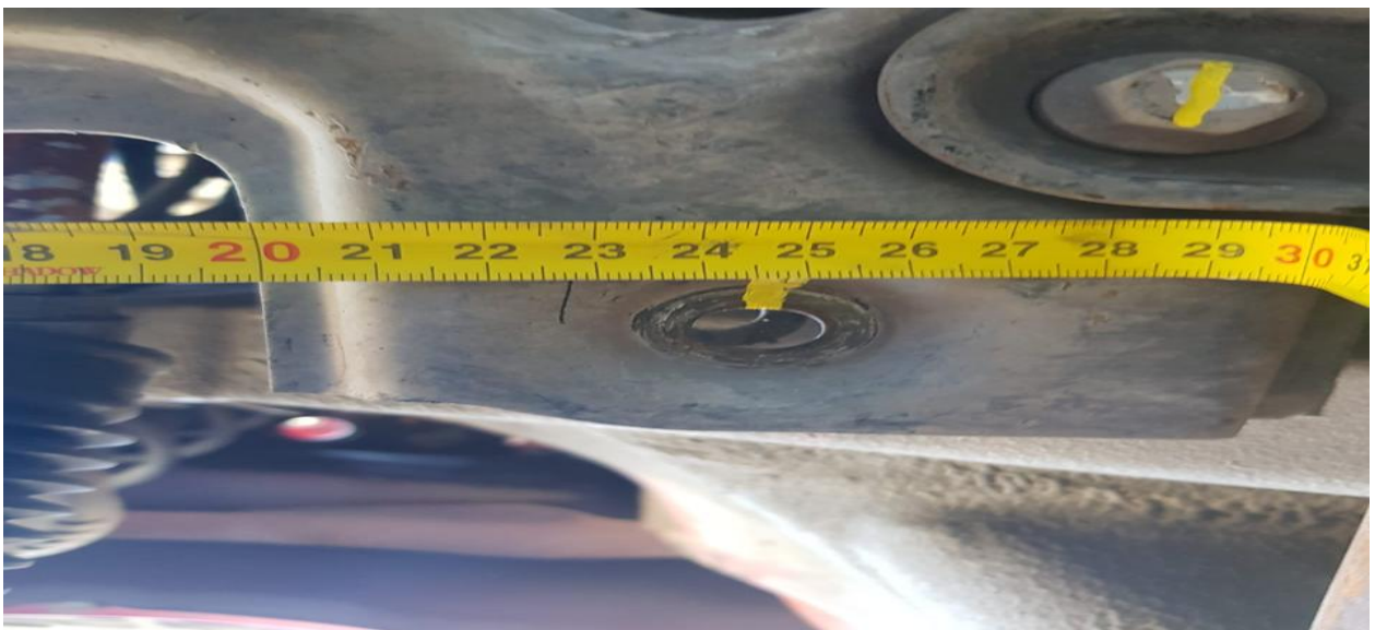
MEDIDA ANCLAJE PARRILLA DE SUSPENSION (245 MM).
