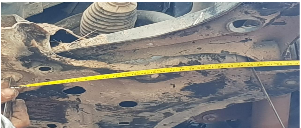
MEDIDA ANCLAJE PARRILLA DE SUSPENSION (250 MM).
