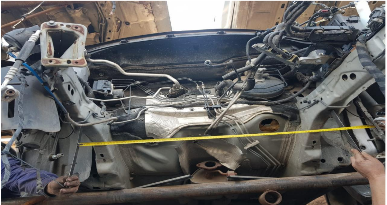
MEDIDA DE ANCHO CUNA DE MOTOR CENTRO A CENTRO SUJECCION DE LARGUERO DE CARROCERIA (930 MM).
