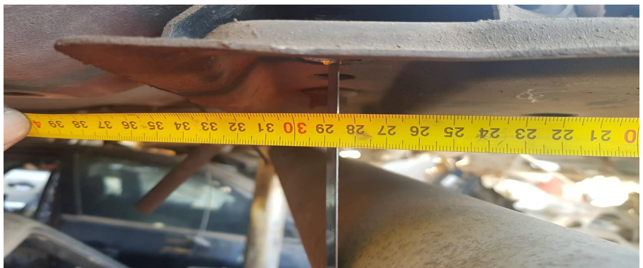
MEDIDA ANCLAJE PARRILLA DE SUSPENSION (285 MM).
