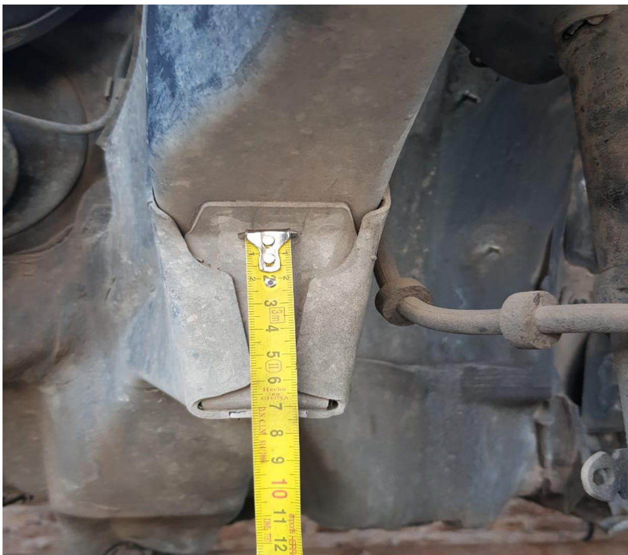
MEDIDA ANCLAJE DE BRAZOS DE CARROCERIA A CUNA DE MOTOR (74 MM)
