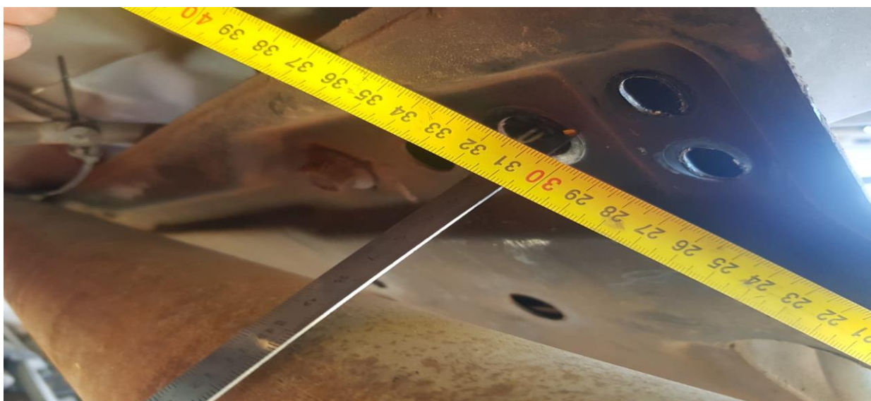
MEDIDA ANCLAJE DE CUNA DE MOTOR CARROCERIA (LARGO LADO PARRILLA 310 MM).
