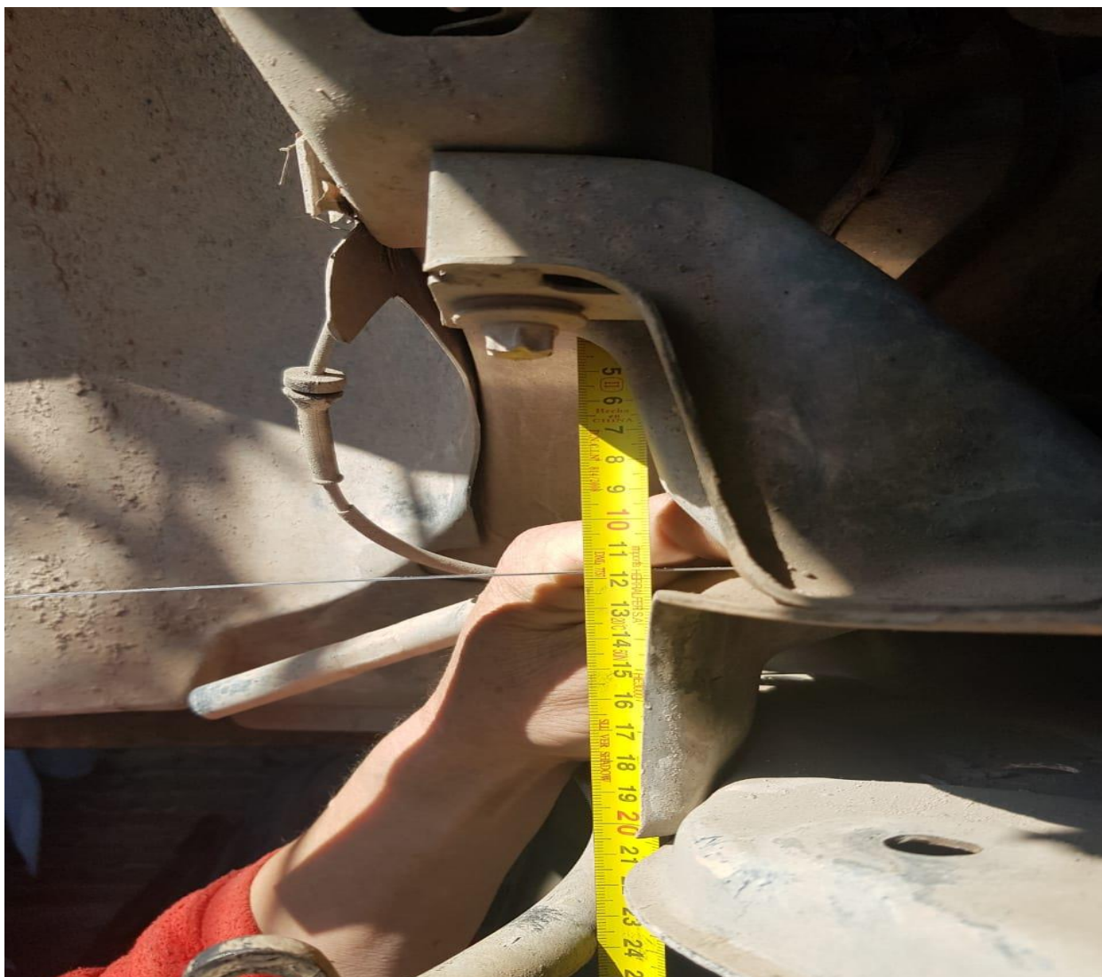
MEDIDA DE BRAZOS CUNA DE MOTOR A ANCLAJE DE CARROCERIA (120MM).
