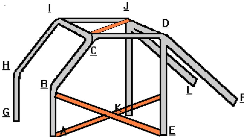
Los puntos A y G del arco delantero, y los E y K del arco principal, y los puntos F y L de los tirantes longitudinales deberán ser soldados a una planchuela de fijación 3/16, la cual estará fijada al piso del vehículo por medio de bulones o soldadura.
