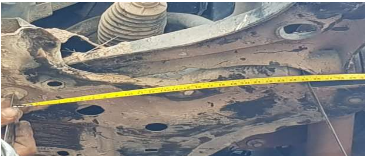
MEDIDA ANCLAJE PARRILLA DE SUSPENSION (250 MM).
