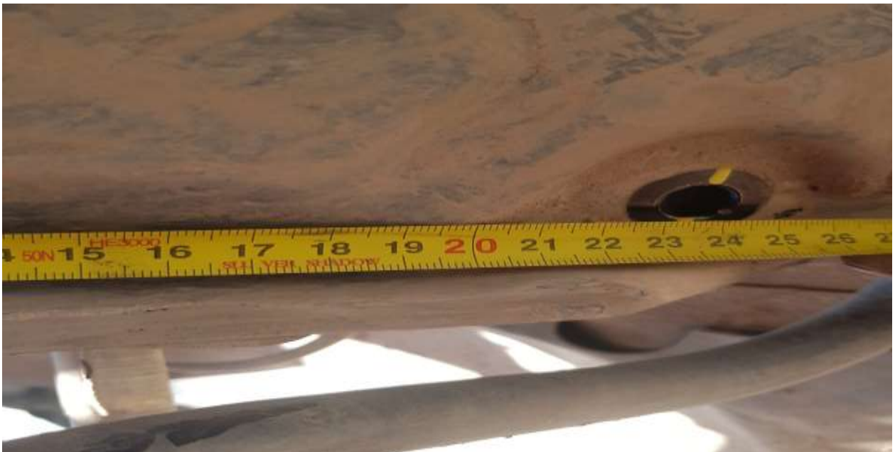
MEDIDA ANCLAJE PARRILLA DE SUSPENSION (240 MM).
