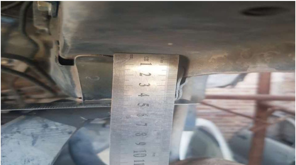
MEDIDA ANCLAJE CUADRANTE DE BRAZOS DE CARROCERIA A CUNA DE MOTOR (50 MM).
