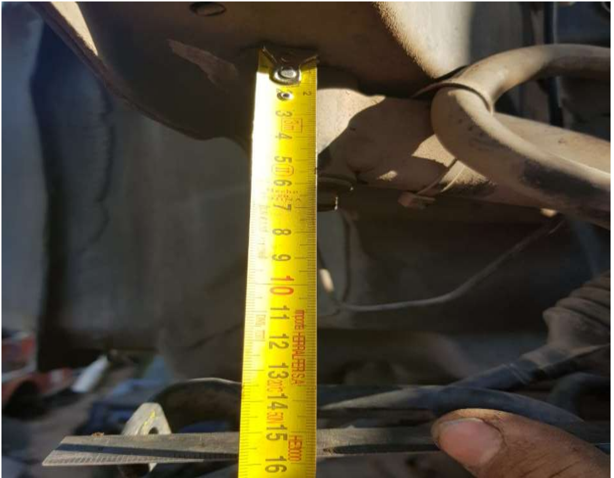
MEDIDA DE BRAZOS CUNA DE MOTOR A ANCLAJE DE CARROCERIA (160MM).
