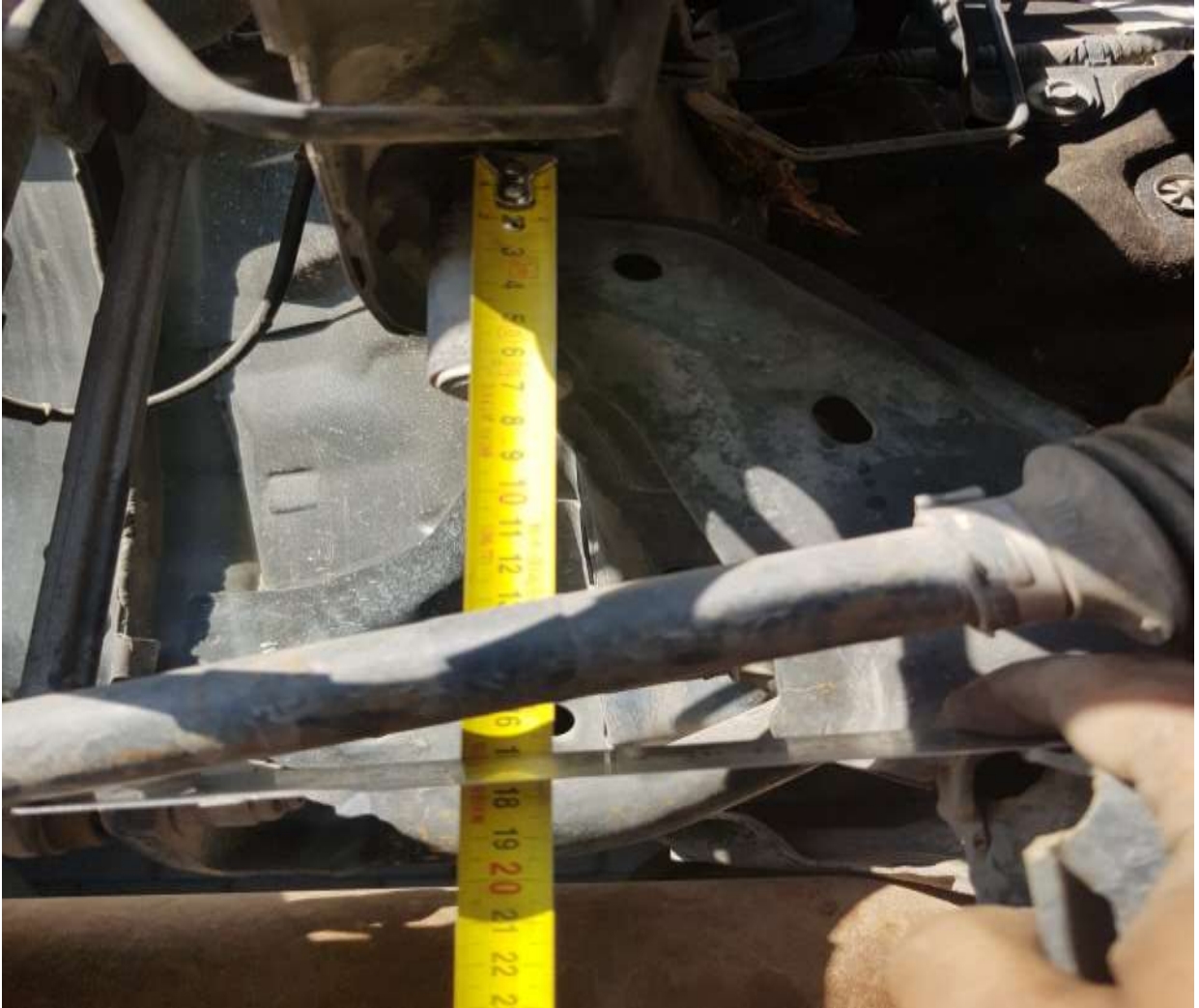
MEDIDA DE BRAZOS CUNA DE MOTOR A ANCLAJE DE CARROCERIA (170MM).
