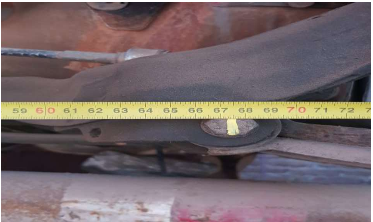
MEDIDA ANCLAJE DE CUNA DE MOTOR (ANCHO DE PARRILLA A PARRILLA 690 MM).
