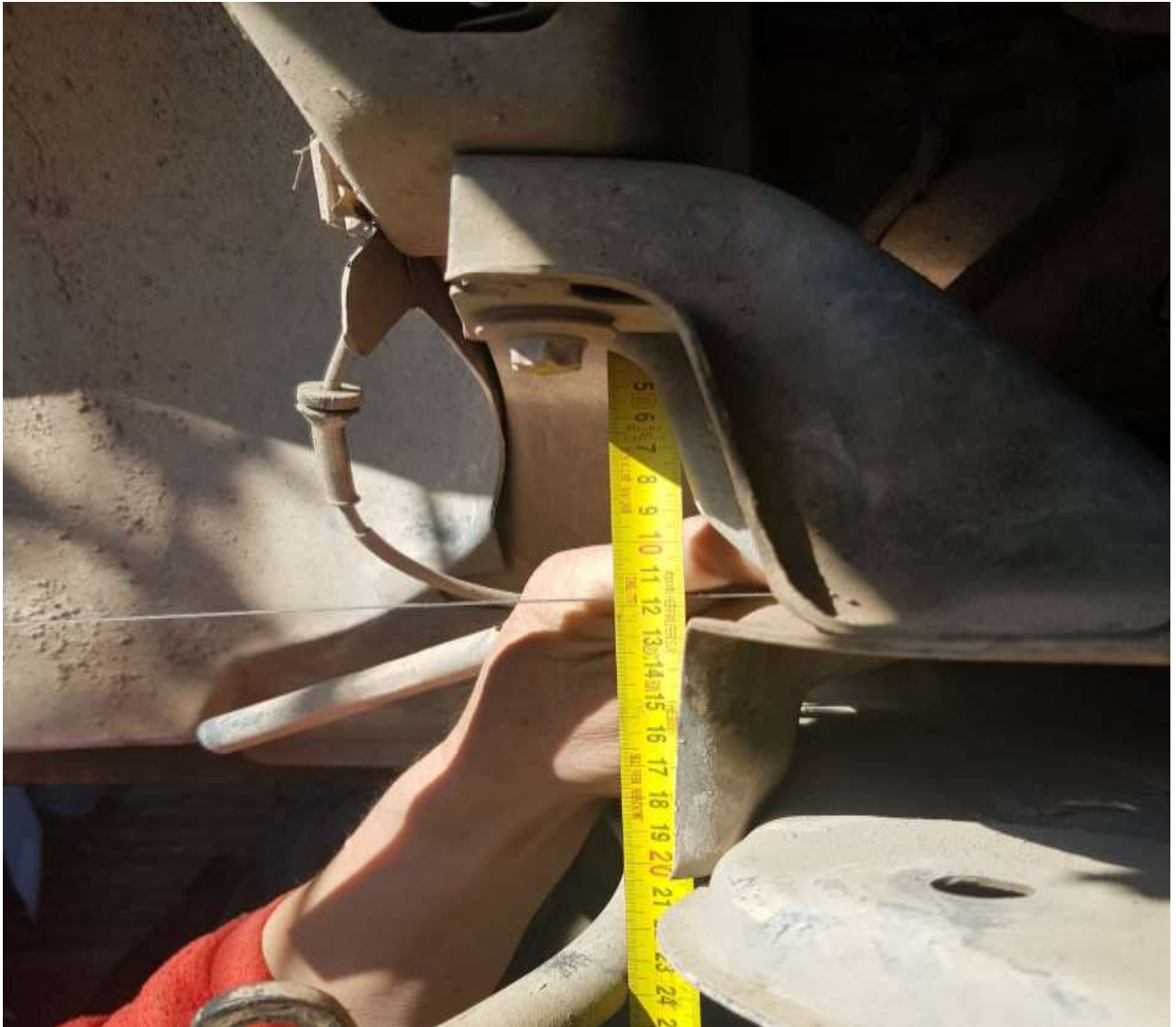
MEDIDA DE BRAZOS CUNA DE MOTOR A ANCLAJE DE CARROCERIA (120MM).
