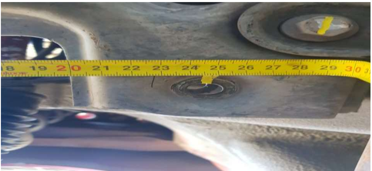
MEDIDA ANCLAJE PARRILLA DE SUSPENSION (245 MM).
