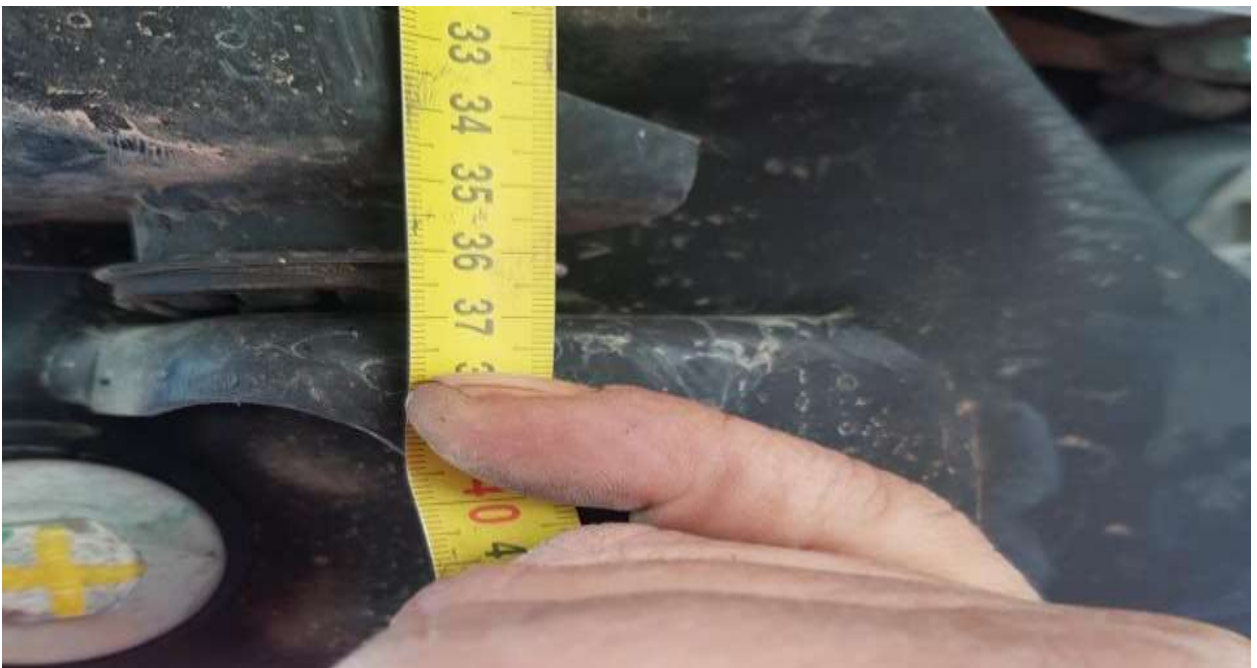
MEDIDA ANCLAJE PARRILLA DE SUSPENSION (370 MM).
