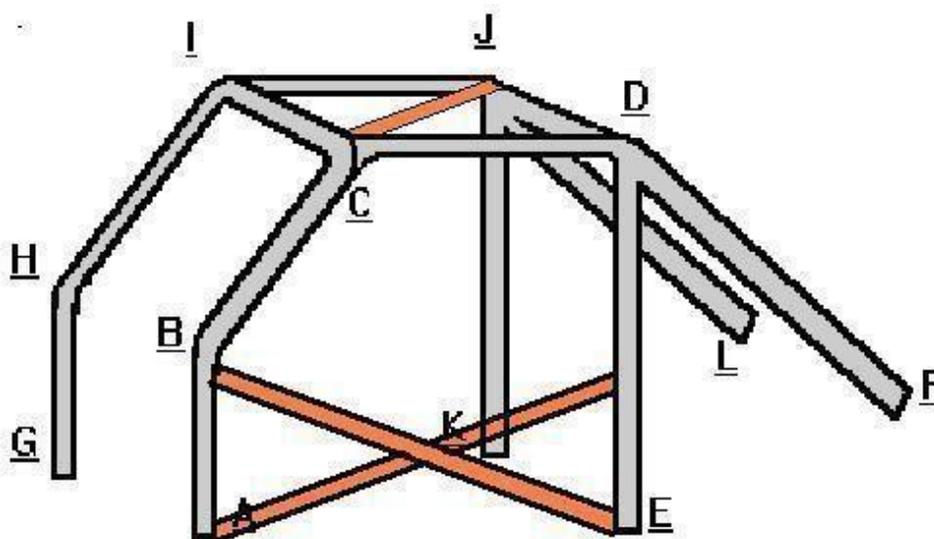
OBLIGATORIA. La estructura del gráfico es el requisito mínimo de jaula de seguridad. Los puntos A y G del arco delantero, y los E y K del arco principal, y los puntos F y L de los tirantes longitudinales deberán ser soldados a una planchuela de fijación 3/16, la cual estará fijada al piso del vehículo por medio de bulones o soldadura.
