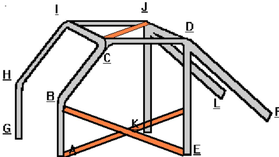
Los puntos A y G del arco delantero, y los E y K del arco principal, y los puntos F y L de los tirantes longitudinales deberán ser soldados a una planchuela de fijación 3/16, la cual estará fijada al piso del vehículo por medio de bulones o soldadura.
