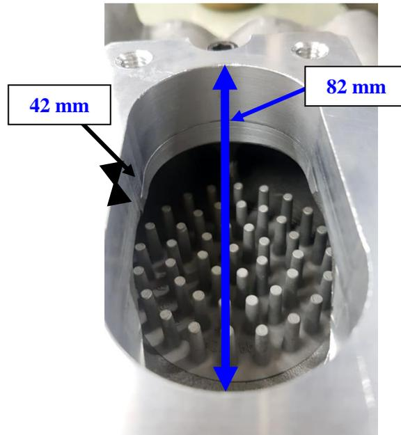
Se podrá tocar el múltiple de admisión del lado externo hasta un máximo de 10 mm hacia el interior para su hermanado con la base adaptadora. (Ver Foto 2)
