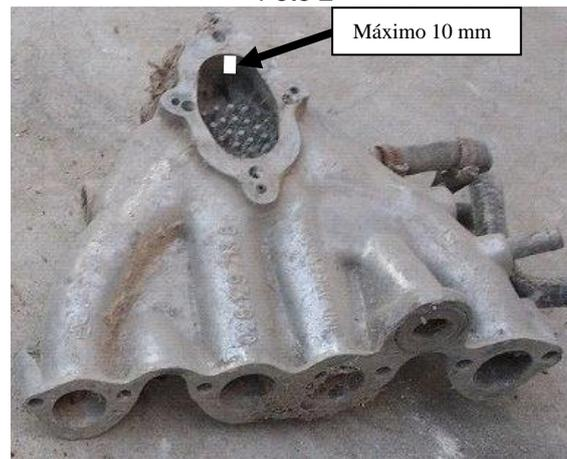
No se podrá poner juntas debajo del mezclador, ni cortar los pernitos de aluminio, que deberán medir no menos de 16mm desde la base.
